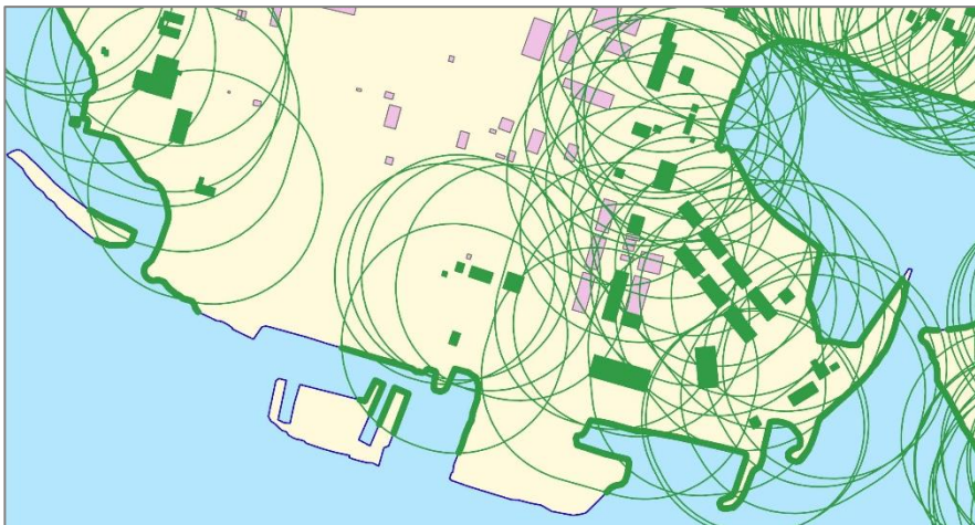
Bild 3. Buffrar som träffar strandlinjen (gröna cirklar) avgör vilka byggnader som klassificeras som strandnära (gröna byggnader) och vilka delar av strandlinjen som klassificeras som exploaterade (gröna linjer).
